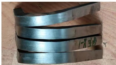
图6 潜弧深熔焊接接头弯曲试验后试样
