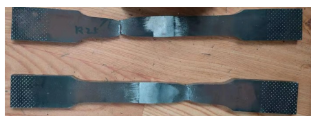
图5 潜弧深熔焊接接头拉伸试验后试样
