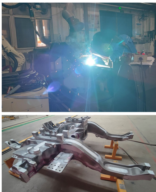
图 15 潜弧深熔焊接试制构架及样件
